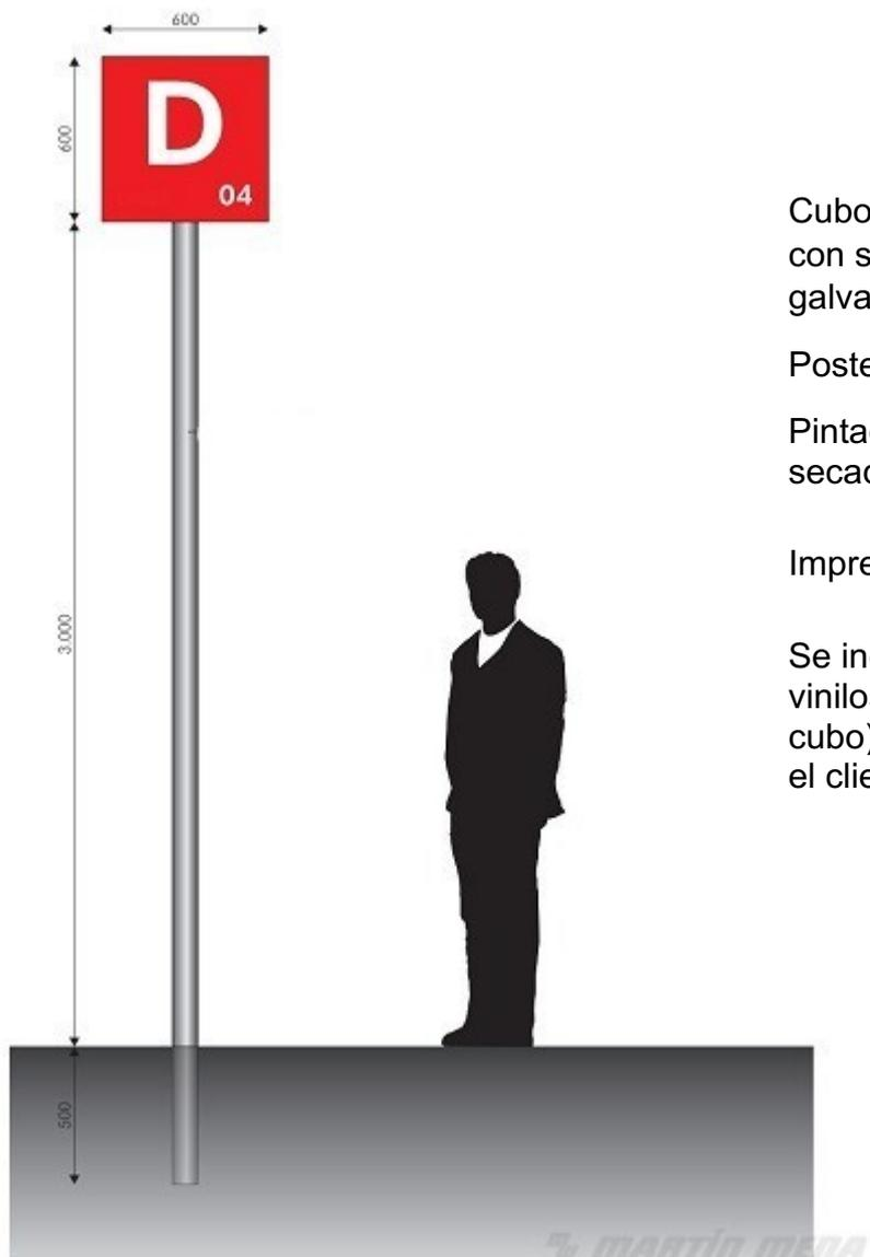
Cubo de acero de 600×600 mm con soporte de acero galvanizado.
